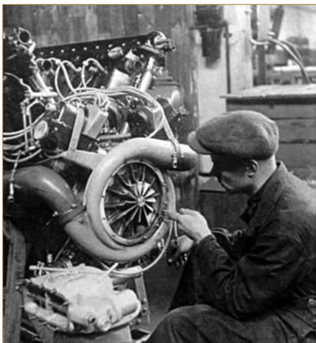
На сборке авиационного двигателя М-105 ПФ. Уфимский моторный завод № 26. 1944 г.
